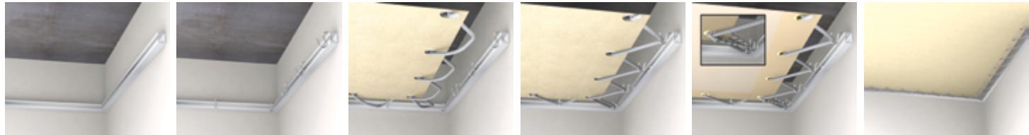
**Trempo® fixation par ressorts - Trempo® fixation by springs - Trempo Befestigung durch Federn | BT320**
