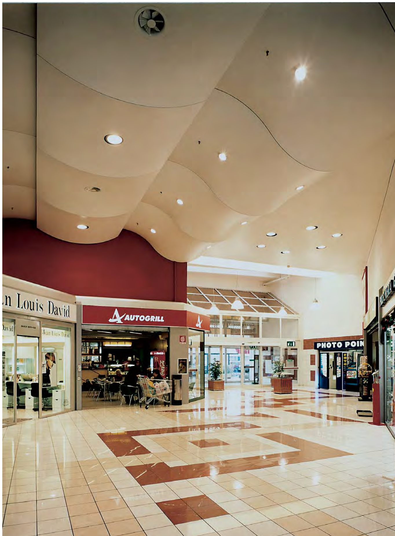
Dans ce plafond aux formes arrondies, sont intégrés les climatisations, spots, lumières et autres éléments techniques.
