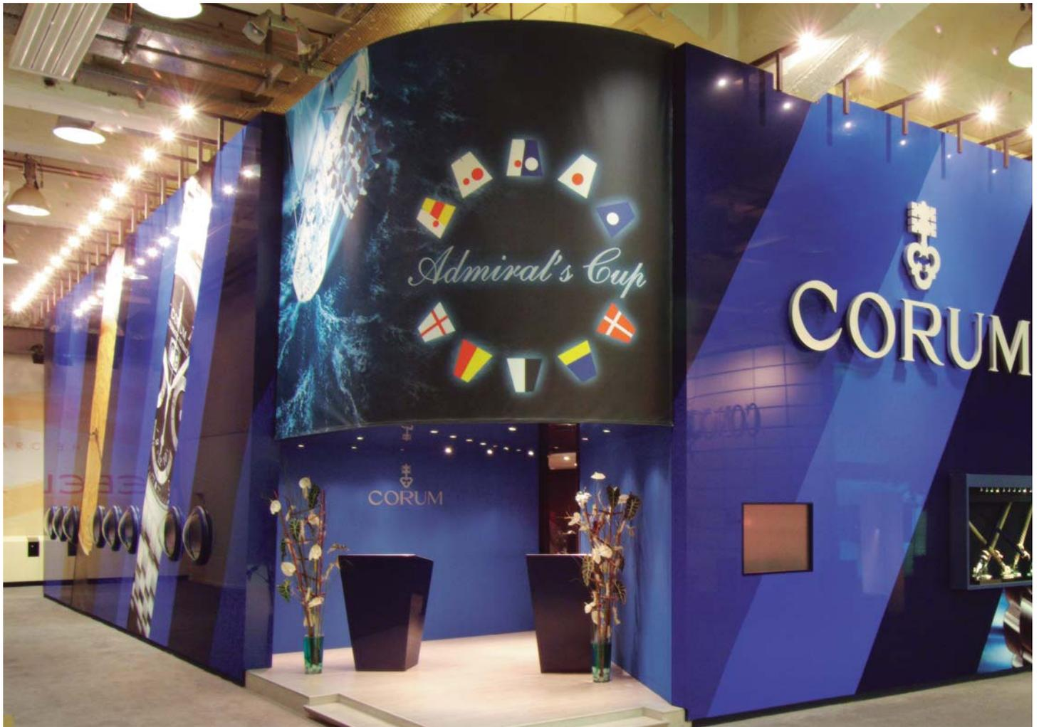
Les murs extérieurs de ce stand sont réalisés en BARRISOL. Des bandes de différents bleus ont été soudées entre elles en diagonale. Des bandes en BARRISOL imprimé s'intègrent dans ce dégradé de bleu.
